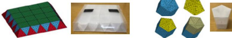
図2 コア81個モデルとPP製ATCP(350×350×55) 図3 コア15個モデルとPP製ATCP (高さ145mm, a=65mm)
