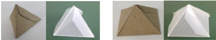
図1 接着剤なしの紙/PP製正四面体コア、正八面体ハーフコア作品例と展開図 (長さa=65mm, 紙厚0.2mm, PPシート厚さ0.3/0.5mm)
