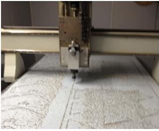
(a) CNCルーターで溝加工
