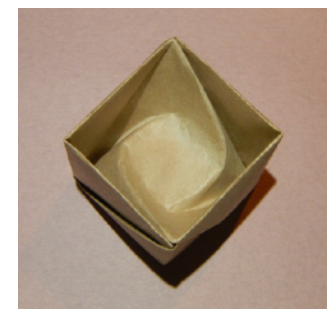
図4：曲線折りによる双曲放物面の近似曲面
