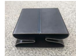
(b)適切な圧潰: 板材は内側変形
