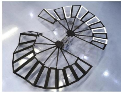
図1 月面基地用の太陽光発電モジュール(1/10 モックアップ)
