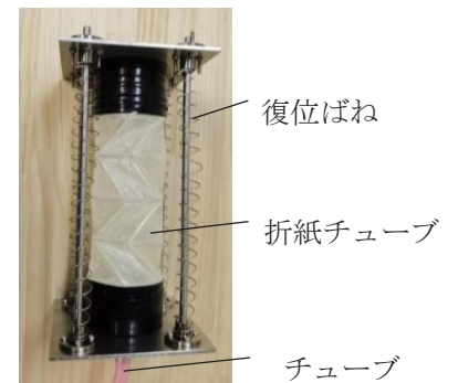
図2. 基本式の折紙型油圧ダンパー
