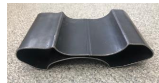
(a)通常の圧潰: 板材は外側変形
