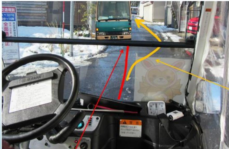
低速無人カートの電磁誘導線の上に駐車車両があるため自動運転車が走れない。
